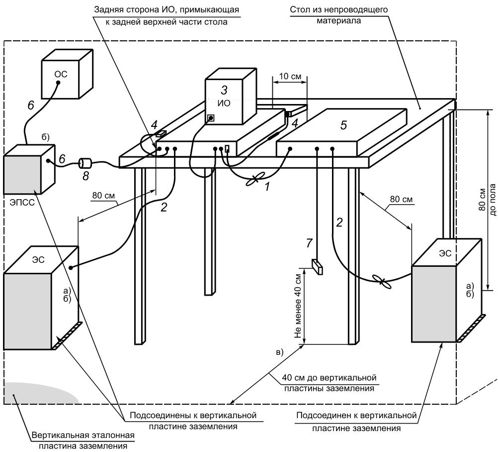
1 — кабели, которые висят на расстоянии менее 40 см от горизонтальной пластины заземления и не могут быть укорочены до подходящей длины; укладываются в связки длиной от 30 до 40 см; 2 — лишнюю часть сетевого кабеля укладывают в связку, расположенную в центральной части, или сетевой кабель укорачивают; 3 — ИО; подсоединяют к одному из применяемых ЭС. Все применяемые ЭС и ЭПСС подключают к горизонтальной пластине заземления (см. рисунки 4 и 7). При этом возможны следующие варианты подключений:
