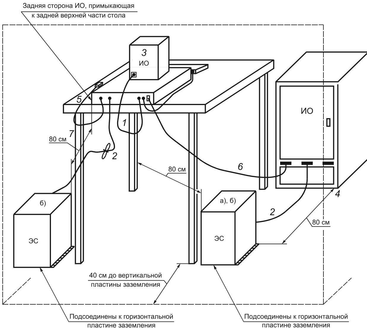
1 — кабели; кабели, которые висят на расстоянии менее 40 см от горизонтальной пластины заземления и не могут быть укорочены до подходящей длины, укладываются в связки длиной от 30 до 40 см; 2 — лишняя часть сетевого кабеля; укладывают в связку, расположенную в центральной части или сетевой кабель укорачивают; 3 — ИО; подключают к одному из применяемых ЭС. Применяемые ЭС подсоединяют к вертикальной пластине заземления. При этом возможны следующие варианты подключения:
