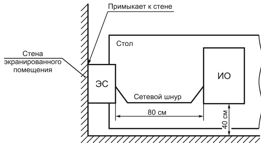
Рисунок 6 — Альтернативное (вид сверху) расположение настольного оборудования при испытаниях
