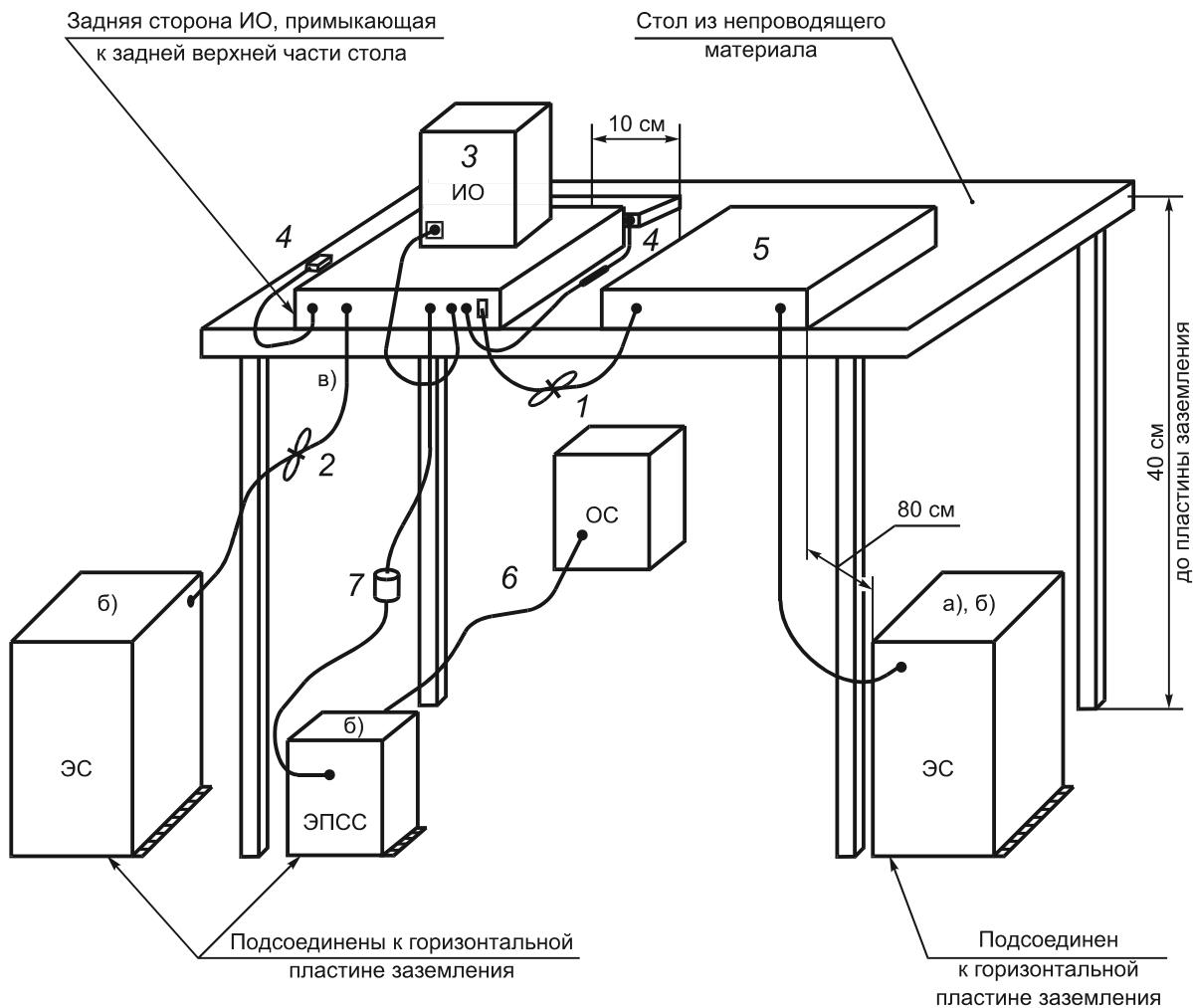
1 — кабели, которые висят на расстоянии менее 40 см от горизонтальной пластины заземления и не могут быть укорочены до подходящей длины; укладываются в связки длиной от 30 до 40 см; 2 — лишняя часть сетевого кабеля укладываются в связку, расположенную в центральной части, или сетевой кабель укорачивают; 3 — ИО; подсоединяют к одному из применяемых ЭС. Все применяемые ЭС и ЭПСС подключают к горизонтальной пластине заземления (см. рисунок 5). При этом возможны следующие варианты подключений:
