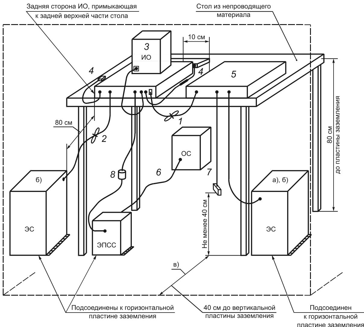
ЭС — V-образный эквивалент сети; ИО — испытуемое оборудование; ОС — оборудование, связанное с ИО;
